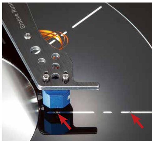
Eine klasse Idee sind die zwei Messpunkte (Pfeile) für den Überhang auf dem Teller. Korrekt eingestellt fluchtet die Headshell mit dessen Hilfslinie.
